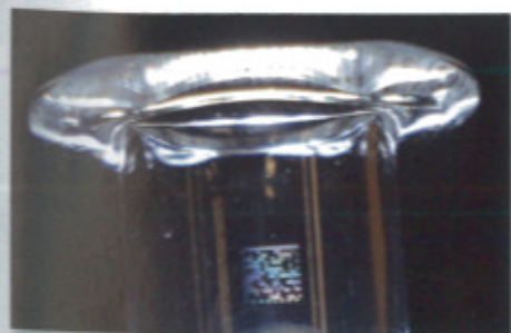
Code Datamatrix inscrit par le procédé Naginels dans l'épaisseur du verre d'une seringue. Source : Trackinside
